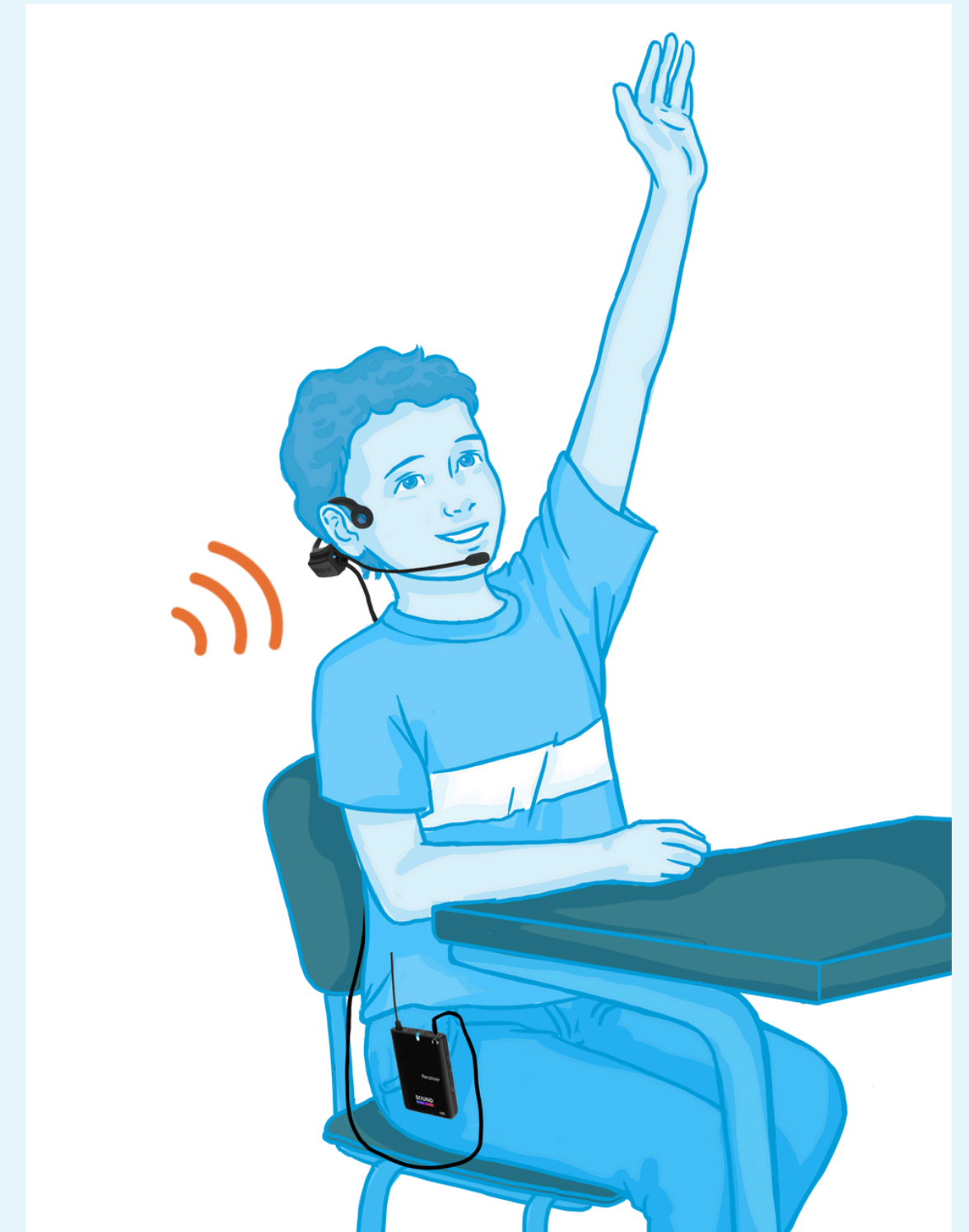
Varios auriculares de conducción ósea (Forbrain) conectados a un receptor para uso de los alumnos.
